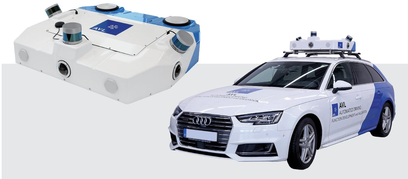
**Bild 2:** DGT-Sensoraufbau (links) und Montage am Testfahrzeug (rechts)
